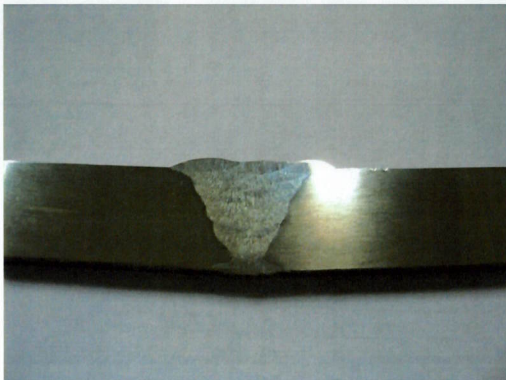
Figura 4.2.1 Aspecto da amostra polida para análise de microestrutura e contagem de fases. Conforme ASTM E562/E1245.
