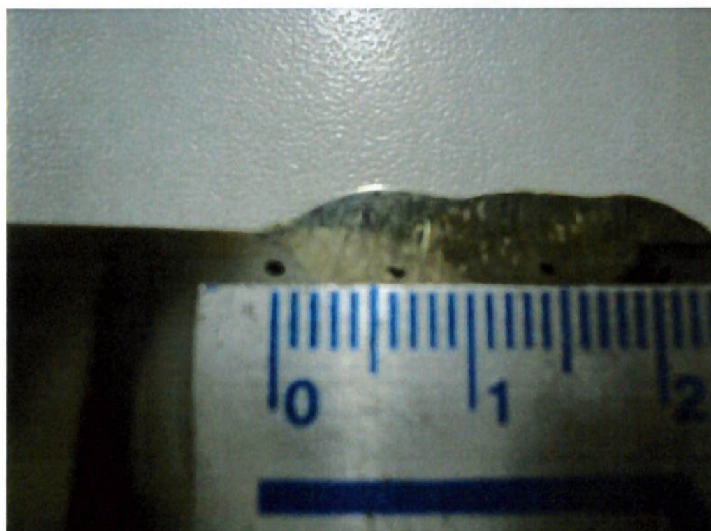
Figura 4.2.3 Corpo de prova marcado para medição de ferrita via ferritoscópio.
