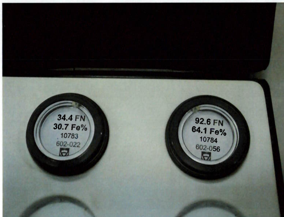
Figura 4.2.2 Padrões utilizados para medição de fase, via ferritoscópio.
