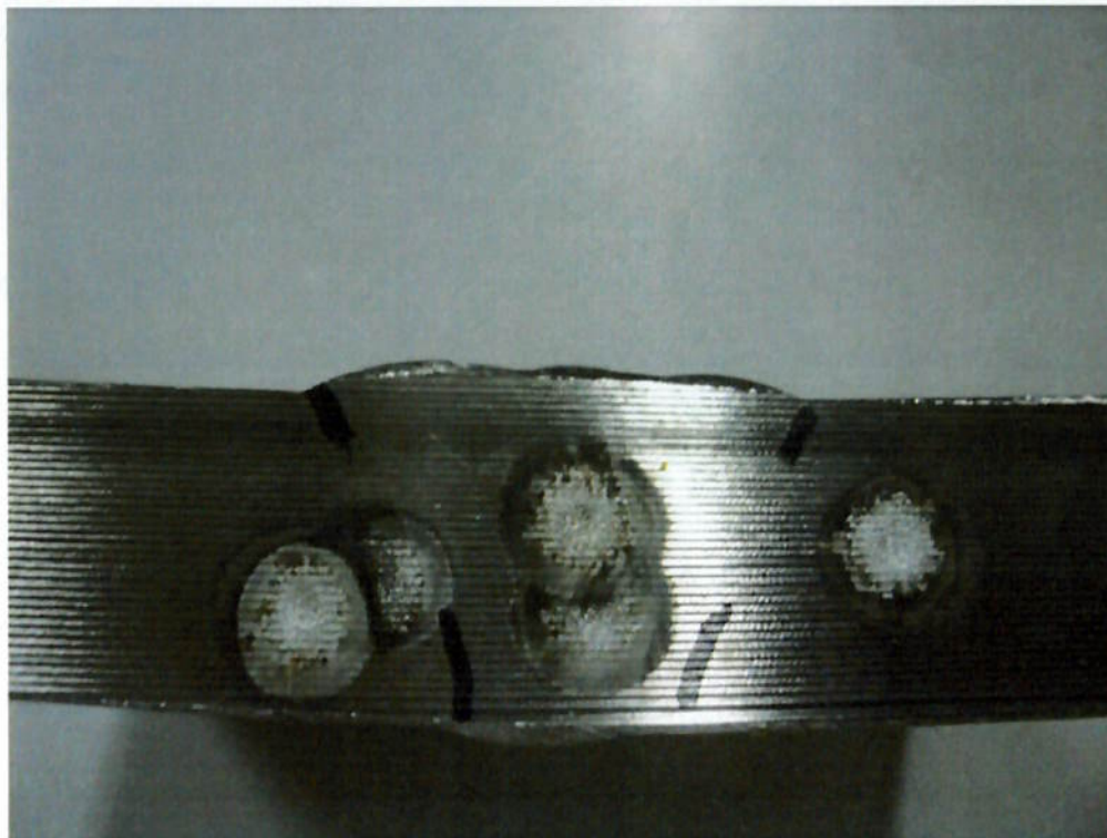
Figura 4.2.1.2 Corpo de prova utilizado para ensaios de análises químicas nas diferentes regiões das soldas e metal de base; via espectrofotometria.
